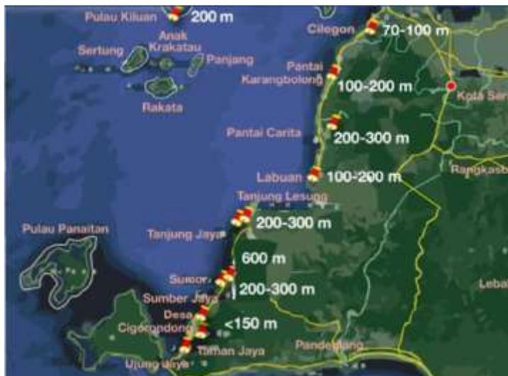
Gambar 3. Distribusi Hasil Survey Pengukuran Jarak Landaan Gelombang Tsunami 22 Desember 2018 (Sumber: Pengukuran BMKG, ESDM, KKP, ITB, IATSI, 2018)
